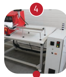
4 Quadro elétrico independente para facilitar a manutenção
